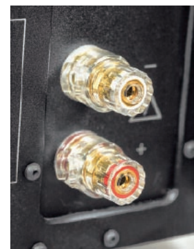
Gniazda głośnikowe WBT są plastikowe i łatwe do zakręcenia. Niektóre egzemplarze (na specjalne zamówienie) firma wyprowadza w jeszcze lepsze gniazda Mundorfa.
