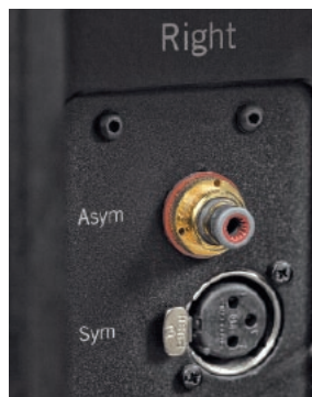
Sygnał można przestać na dwa sposoby: kablem zbalansowanym lub niezbalansowanym.
