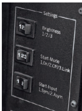
Zestaw przełączników na tylnej ścianie: jaskrawość wyświetlacza, sposób włączania urządzenia oraz wejście aktywne po włączeniu.
