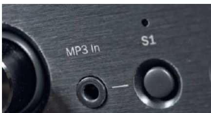
Wejściom liniowym towarzyszy umieszczony z przodu port dla odtwarzacza przenośnego – mini-jack.
