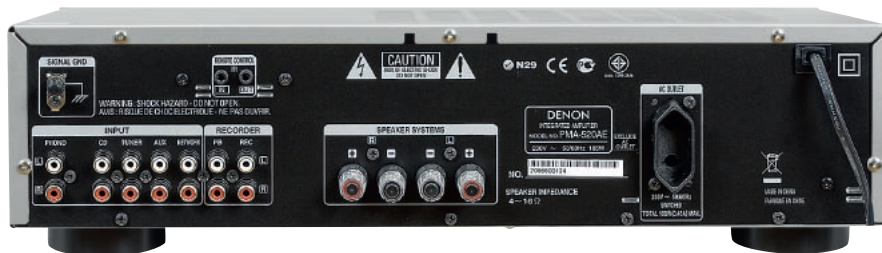
Podstawowe, lecz kompletne wyposażenie, jedno z wejść liniowych zadeklowano odtwarzaczowi sieciowemu.
