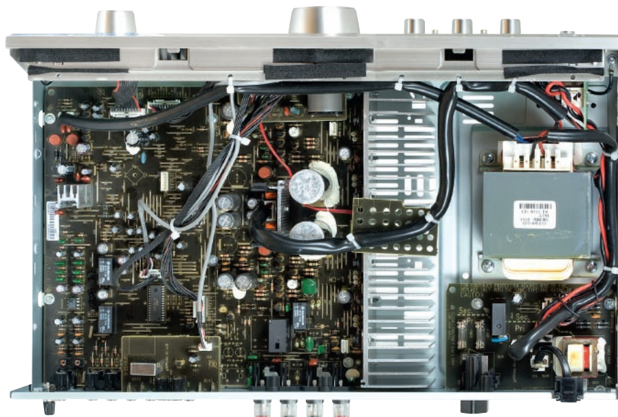
Większość obwodów wlutowano w główną płytkę, radiator oddziela sekcję audio od sporego zasilacza.
