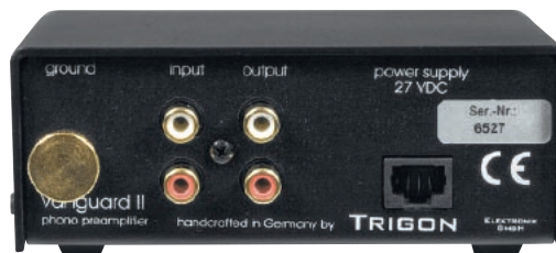
Uwagę zwraca nietypowe gniazdo zasilania – spotykane raczej w sieciach ethernetowych.
