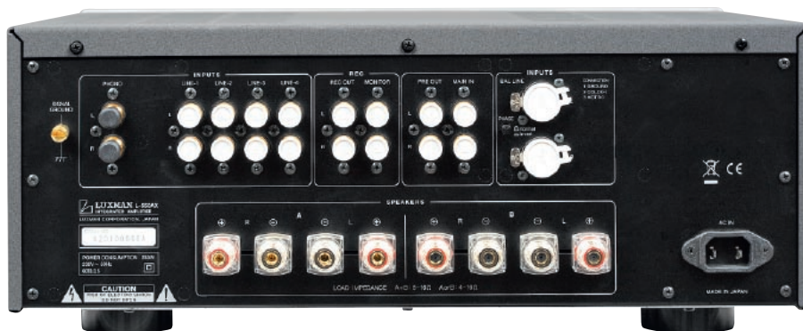
W górnym szeregu umieszczono wejścia liniowe i gramofonowe, pętlę do nagrywania, wyjście z przedwzmacniacza oraz wejście na końcówkę siły głosu i wejście zbalansowane. Na dole są wyjścia głośnikowe – dwie pary.
