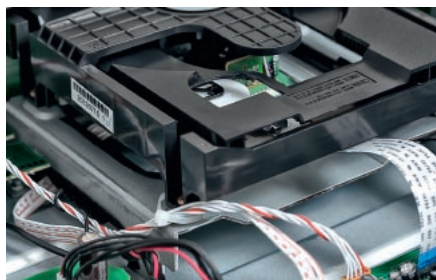
Starania konstruktorów w nowym CD6005 skupiły się w głównej mierze na dopieszczeniu mechanizmu i tłumieniu drgań.
