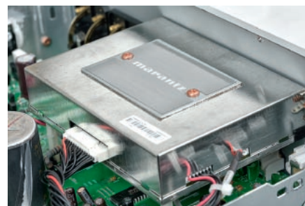
Wejścia cyfrowe wraz z układami przetworników umieszczono w niezależnej, metalowej obudowie, sygnał analogowy jest jednak przesyłany na główny druk za pomocą przewodu.
