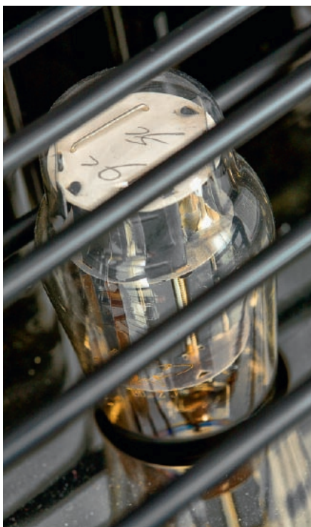
Ukryte w klatce lampy to podwójne, pośrednio żarzone triody 6AS7. Pierwotnie pracowały w zasilaczach jako lampy stabilizujące napięcie DC.
