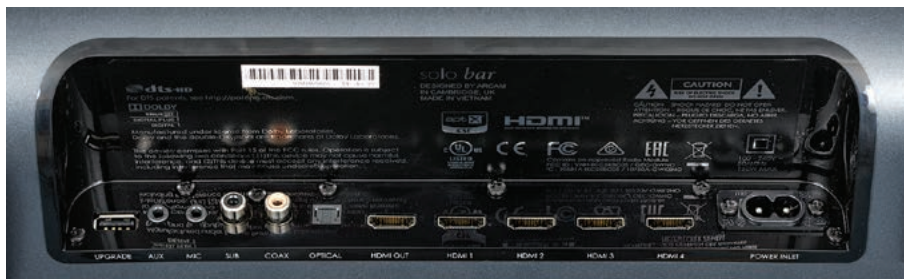
Nowocześnie i na bogato – są złącza HDMI, ale również gniazda optyczne, współosiowe oraz analogowe. Elektronika kryjąca się za złączami HDMI obsługuje nawet sygnały 4K.
