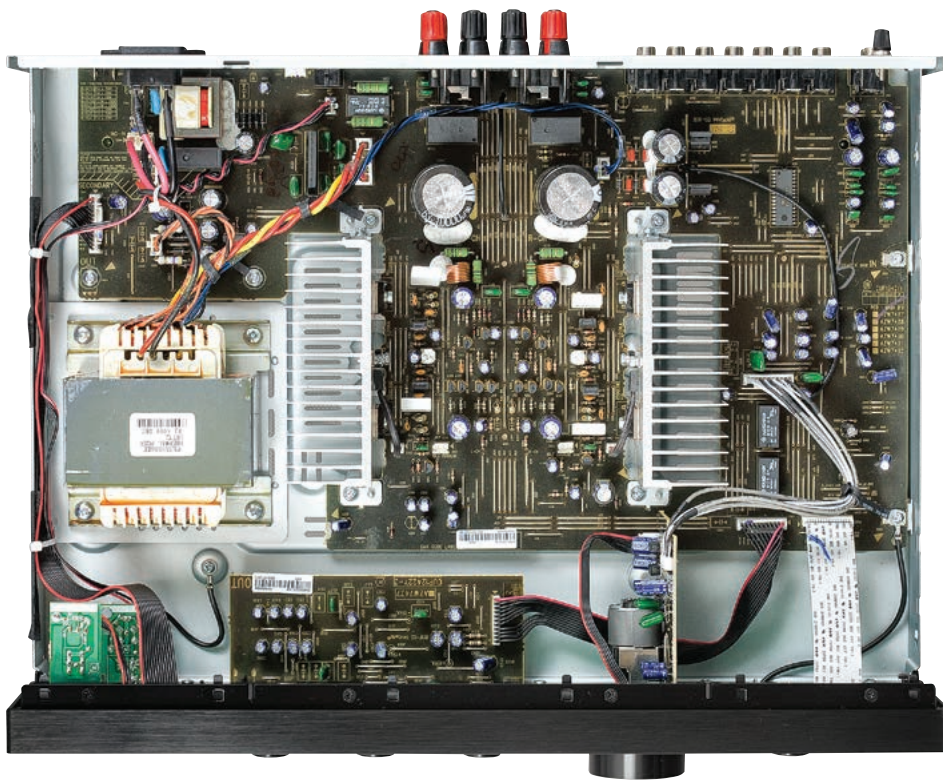
Pioneer zastosował pojedynczy transformator, ale końcówki mocy podzielił na dwa moduły – każdy z niezależnym radiatorem.
