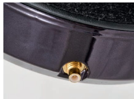
Odkładane od każdej muszli kable z miniaturowymi, ale solidnie wykonanymi zakręcanymi gniazdami.
