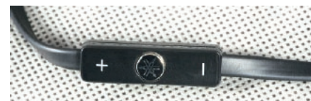
Na płaskim kablu umieszczono miniaturowy sterownik z mikrofonem.
