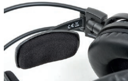
Jeden z firmowych patentów Audio-Techniki - samoregulujące skrzydełka 3D Wings.
