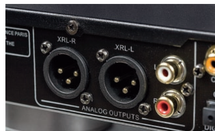
Wyjścia analogowe są nie tylko niezbalansowane, ale także zbalansowane (na gniazdach XLR).
