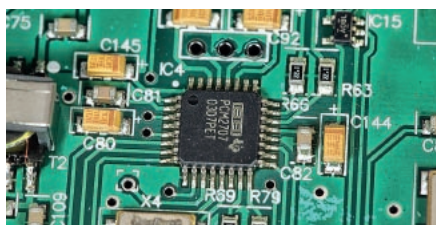
Wejście USB oparto na słabej kości PCM2707, obok upsampler SRC4391 i wspianiałe zegary taktujące.
