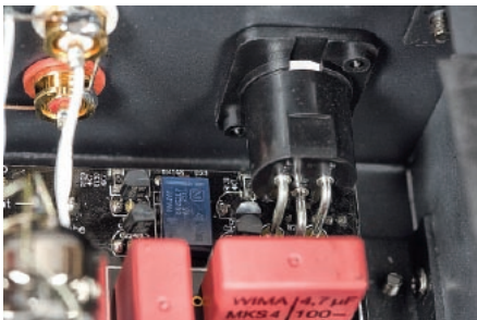
Przy wyjściach pracują przekaźniki, dzięki którym sygnał jest wyłączany na czas przełączania wejść.
