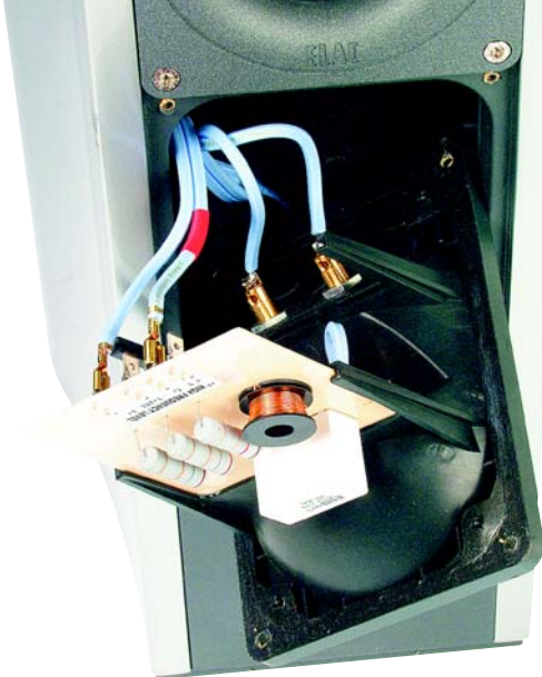
Filtr przetwornika 4Pi zainstalowano na obudowie gniazda przyłączeniowego.
