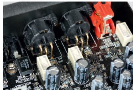
Przetwornik C/A jest dwukanałowy, sygnał zbalansowany powstaje w układach analogowych.
