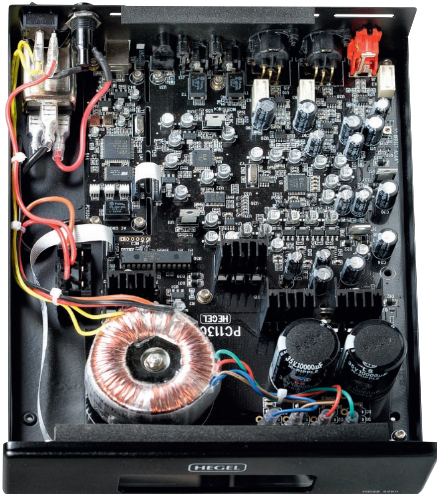
Główną płytkę przetwornika odseparowano od wejścia USB, rozbudowany zasilacz bazuje na transformatorze toroidalnym.
