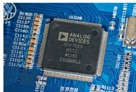
Obsługę sygnałów z wejść HDMI (oraz ich przełączaniem) zajmuje się układ Analog Devices.
