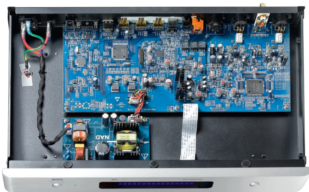
Całość układów cyfrowych i analogowych zmieściła się na dużej płytce.
