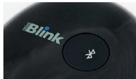
Klasyczny przycisk parujący urządzenia – rozwiązanie bez wygody automatyczności, za to z zabezpieczeniem przed niechcianymi „nadawcami”.
