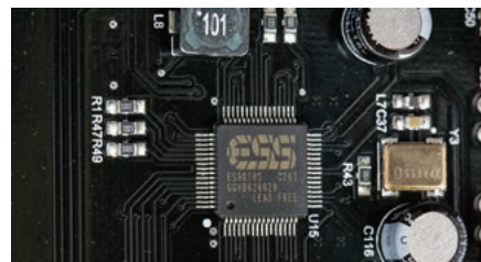
Mózg konwersji cyfrowo-analogowej – ośmiokanałowy układ ESS9018.
