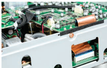
Na dolnym poziomie ułożono najważniejsze układy konwersji C/A oraz komplet obwodów analogowych z modułami HDAM.
