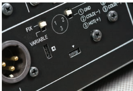
W zależności od systemu, w którym urządzenie ma pracować, można wybrać stały lub zmienny poziom wyjść analogowych, zadbane nawet o przełącznik konfiguracji złącz XLR.
