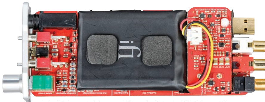
Duża, obłożona materiałem „paczka” to ogniwa bateryjne. Układy konwertujące zbudowano z dwóch skalaków Texas Instruments.
