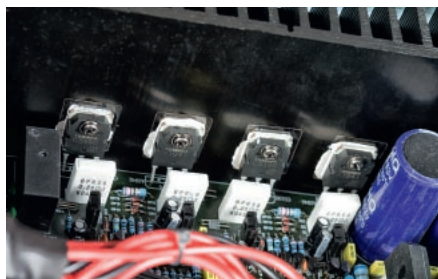
Solidny wzmacniacz, z tranzystorami Toshiba na końcu – słud i brzmienie porządne, chociaż niespektakularne.
