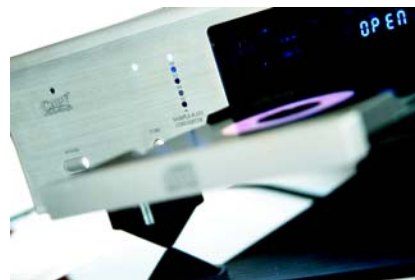
Po lewej stronie umieszczono przełączniki i wskaźniki upsamplingu oraz wyłącznik lampowego bufora wyjściowego.
