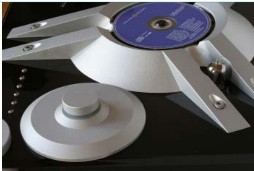
“Ramiona” metalowej konstrukcji posadzonej wokół mechanizmu kryją lampy wyjściowe.
