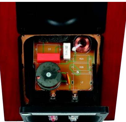
Zwrotnicę zamontowano na dwóch płytkach, przymocowanych bezpośrednio do zacisków gniazda przyłączeniowego. Zwłaszcza sekcja wysokotonowa jest bardzo rozbudowana - zawiera aż trzy cewki, co w filtrach górnoprzepustowych rzadko się zdarza.
