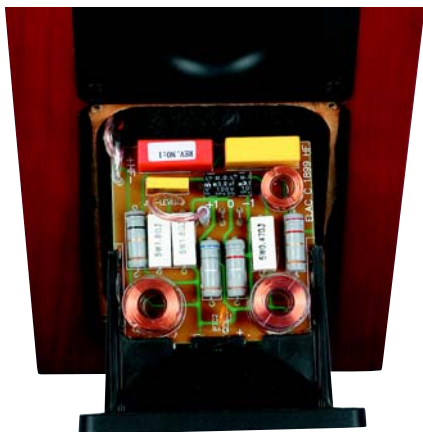
Zwrotnicę zamontowano na dwóch płytkach, przymocowanych bezpośrednio do zacisków gniazda przyłączeniowego. Zwłaszcza sekcja wysokotonowa jest bardzo rozbudowana - zawiera aż trzy cewki, co w filtrach górnoprzepustowych rzadko się zdarza.
