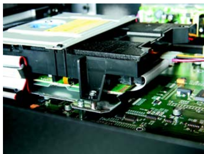
Mechanizm zamontowano na sztywnej ramie i dedykowano mu osobny zasilacz.
