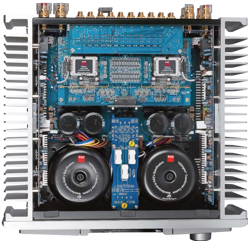
Transmisja prądów o wysokim natężeniu odbywa się za pomocą złożonych szyn.
