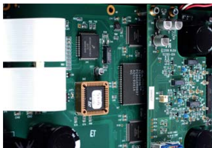
Sekcja cyfrowa jest wyjątkowo rozbudowana. Upsamplowany sygnał z CD przechodzi potem przez cyfrową regulację głośności.
