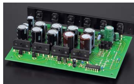
Konstrukcja zasilacza DP-700 opiera się na wielu niezależnych uzwojeniach wtórnych, za każdym pracuje prostownik i bateria stabilizatorów.
