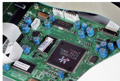
To już widzieliśmy w odtwarzaczu Advance Acoustic – sterowanie napędem DVD oraz kompletne dekodery obrazu i dźwięku kinowego.
