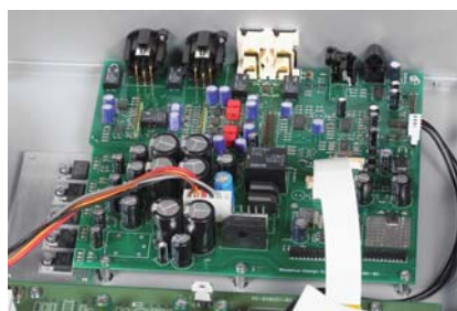
Szwedzki odtwarzacz wyróżnia się rozbudowanym zasilaniem oraz ładną sekcją audio.
