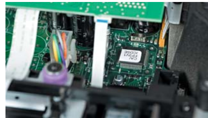
Serce, a raczej mózg CD Xt SE - programowalna kość sterująca napędem.
