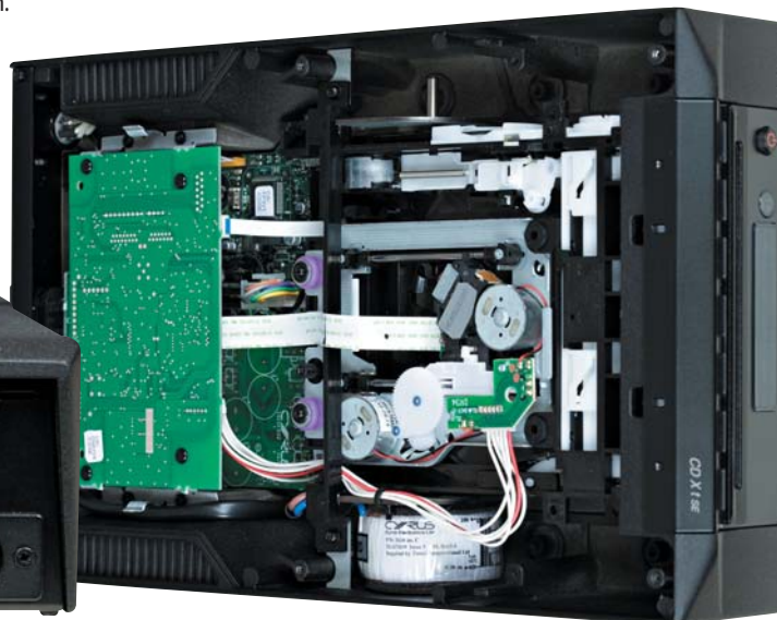
Jak we wszystkich Cyrusach, tak i w transporcie CD Xt SE elektronika oraz napęd przykręcone są do górnej ścianki.
