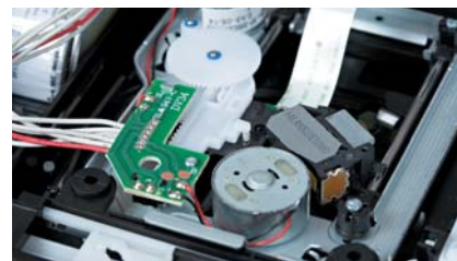
Główną część mechanizmu zaczerpnięto z transportu Philipsa, optykę zapożyczono z DVD, oprogramowanie napisano pod kątem płyt CD.
