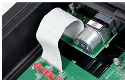
Czarny potencjometr Alpsa - przez lata sprawdzony w głównej roli regulacji wzmacnienia.
