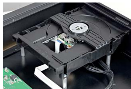
Napęd wygląda na jednostkę Sony, ale z optyką DVD.
