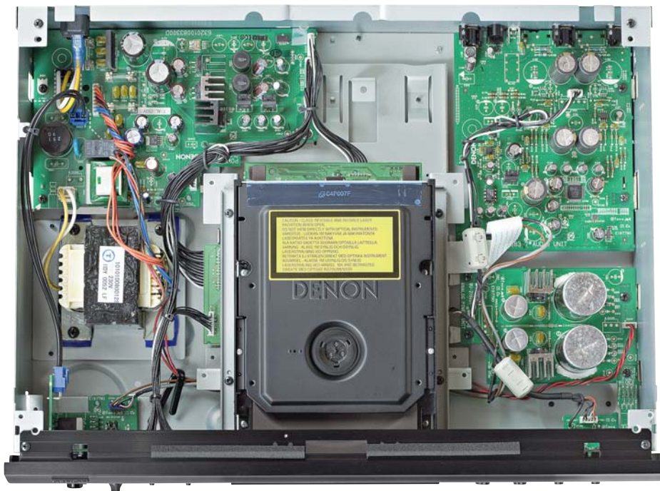
Wnętrze nowego odtwarzacza Denona całkowicie przeprojektowano, rozsunęto bloki zasilania i układów audio.
