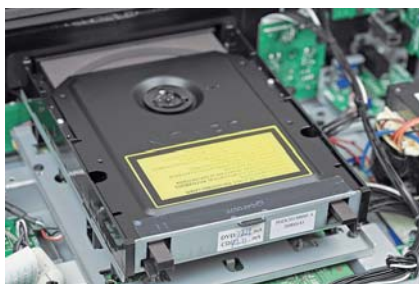
Napęd DVD wzmocniono dolną płytą, na której mocowana jest rama.
