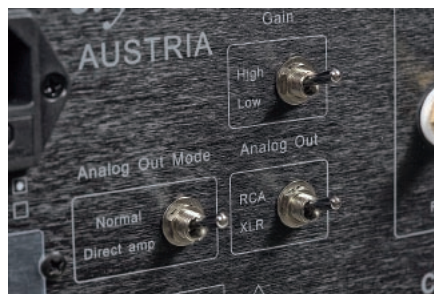
Przełączniki na tylnej ścianie służą dopasowaniu zakresu regulacji poziomu wyjściowego do konkretnego systemu.
