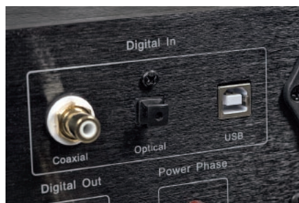
Wejścia cyfrowe w CD już nie dziwią – tutaj mamy komplet – RCA, optyczne i USB, wszystkie hi-res!
