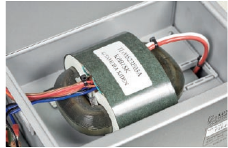
We własnej komorze, przykręcony do drugiej podłogi (a ta do bocznych ścianek) siedzi transformator R-core.
