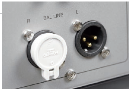
Podobnie jak w Accuphase, gniazda Luxmana można zatkać plastikowymi elementami - tylko po to, żeby się do środka nie kurzyło.
