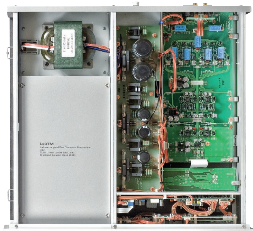
Wnętrze podzielone ekranami, które wzmacniają obudowę. Osobnym ekranem przykryty jest napęd.
