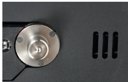
W wycięciu widać pasek napędzający oś, na której leży płyta CD.
