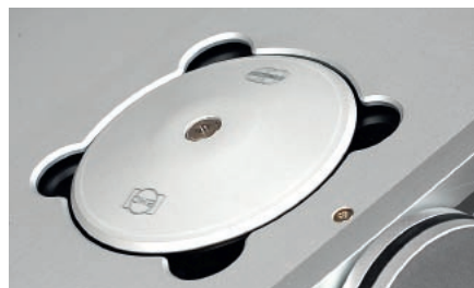
Widoczny od góry krążek nie jest pokrywą – to dość ciężki docisk.
