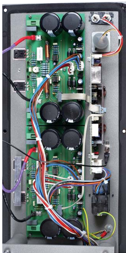
Wzmacniacz składa się z dwóch sekcji – po jednej dla każdego głośnika – z parami tranzystorów końcowych w każdej z nich.
