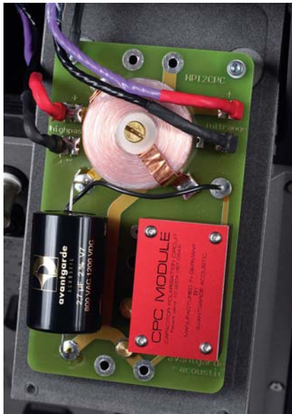
Polaryzacja kondensatora filtra głośnika wysokotonowego to kolejna rzadko spotykana technika, której sens został jednak naukowo dowiedziony. W dodatku elementy filtra są najwyższej klasy.
