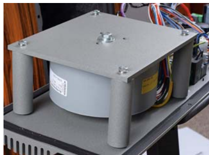
Wspólny transformator o mocy 540 VA, odizolowany od radiatora warstwą tłumiącą wibracje.
