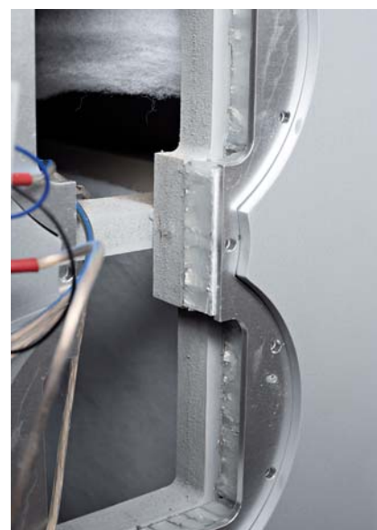
Front jest nie tylko gruby, ale i wielowarstwowy: najgłębiej widać 2 cm mdf-u, dalej aluminiowy plaster miodu o podobnej grubości, potem gruba blacha aluminiowa, na której opierają się głośniki, na wierzchu kolejna warstwa mdf-u już polakierowana, licująca z płytami głośników.
