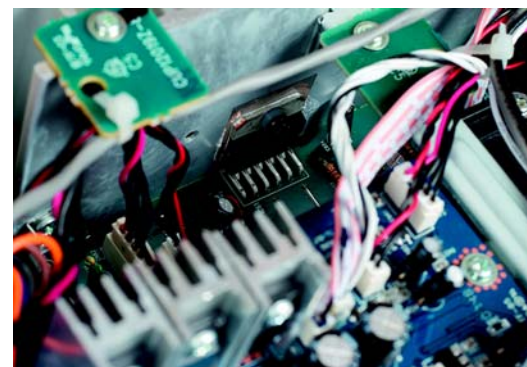
Końcówka mocy pracuje na bazie wspólnego dla obu kanałów układu scalonego.
