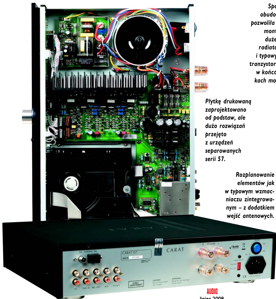
Sekcję cyfrową skopiowano z projektu odtwarzacza CD, także i tutaj znalazł się dekodér HDCD.
