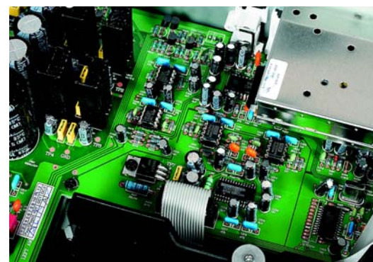
Sekcję cyfrową skopiowano z projektu odtwarzacza CD, także i tutaj znalazł się dekodér HDCD.
