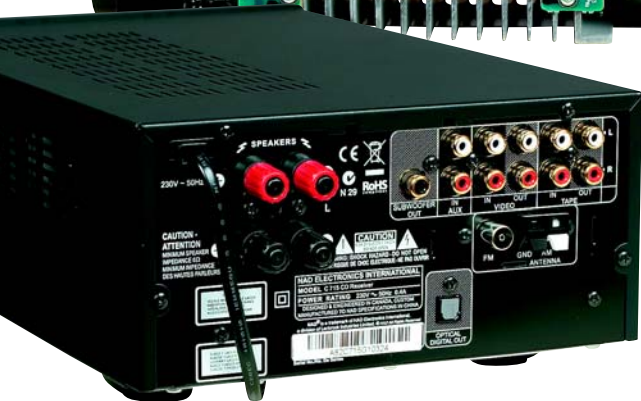
C715 jest wyposażony w aż dwie pętle dla rejestratorów.
