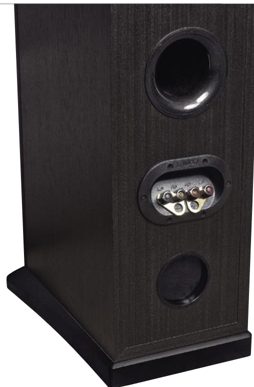
Od góry: bas-refleks, podwójne gniazdo w oprawce typowej dla Mission i zaślepiiony otwór, przez który można wypełnić balastem dolną, odseparowaną komorę. O tej możliwości producent nie wspomina w podstawowych informacjach, a to przecież cecha, która może być zachęającym argumentem, zwłaszcza dla audiofilów
