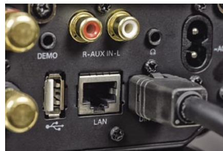
Złącze sieci LAN w sąsiedztwie portu USB.
