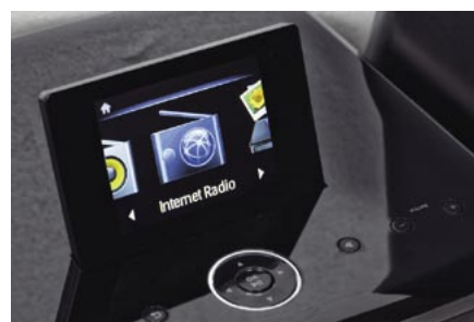
Zamiast drobnego wyświetlacza, Philips zastosował pochylony panel z dużą, kolorową matrycą LCD, dla źródeł przygotowano efektowne ikony.
