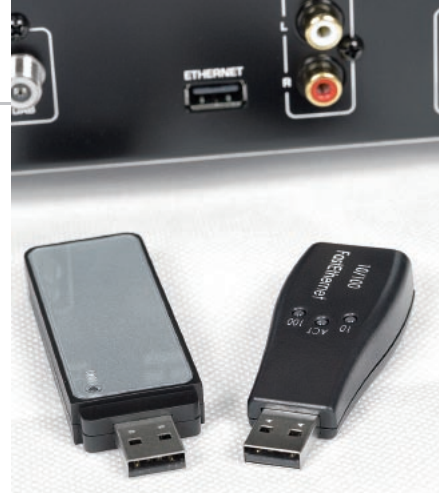
Rotel nie ma klasycznego gniazda Ethernet, a z siecią łączymy się za pomocą przejściówek – nadajnika/odbioru WLAN albo USB-Ethernet.
