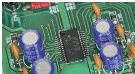
DAC Wolfsona WM8740 – układ 24-bitowy, 192 kHz, o dynamice 117 dB i niskich zniekształceniach.
