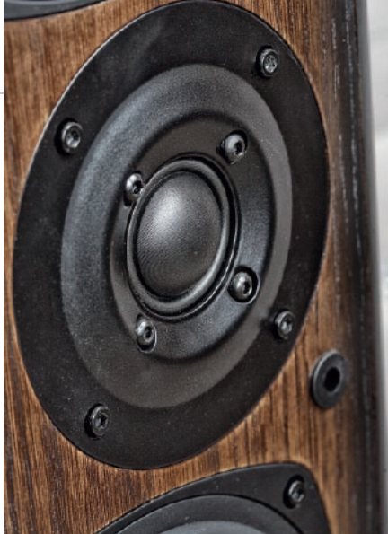
Jedwabna kopułka wysokotonowa ma średnicę 28 mm – nieco większą od jednocalowego standardu.
