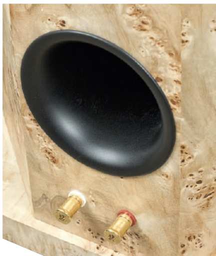
Z tyłu, prawie na samym dole, wyprowadzono tunel bas-refleksu, wcale nie za duży, do obsługi 33-cm niskotonowego. Poniżej nierzucająca się w oczy para zacisków WBT – tych tańszych, ale oryginalnych.
