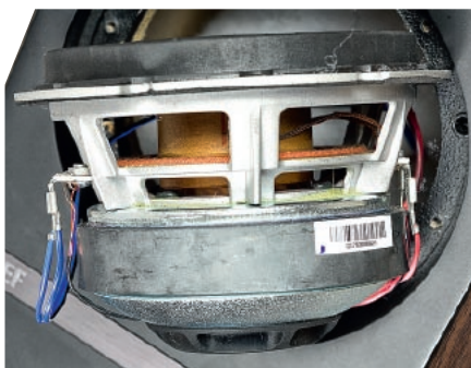
Odlwany kosz i silny układ magnetyczny – fundament najnowszego Uni-Q. Charakterystyczna duża cewka nisko-średniotonowej i wystający kołnierz górnej zawieszania; oczywiście obowiązkowe są niezależne doprowadzenia do cewek obydwu przetworników.
