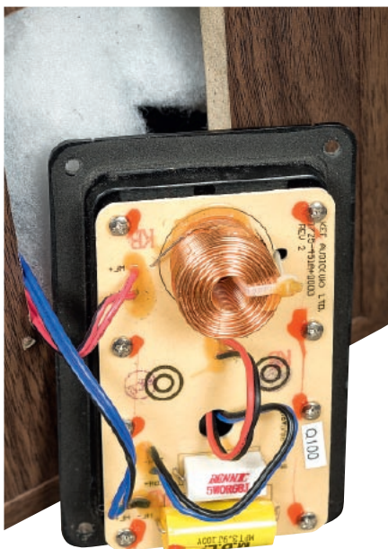
Wcześniej zwrotnice KEF-a były o wiele bardziej skomplikowane – minimalistyczny układ filtrów 1. rzędu pojawił się wraz z najnowszą serią Q. Uzyskanie przy takim filtrowaniu wyrównanej charakterystyki – to duży sukces.
