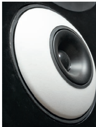
Koncentryczny BC17 to układ dwudrożny, średnio-wysokotonowy; membrana średniotonowa (biała) ma formę wycinka torusa, wysokotonowa to kopułka, przed którą znajduje się tubowe wyprofilowanie „układające” jej charakterystykę i pozwalające ustawić w optymalnej relacji obydwie przetworniki.
