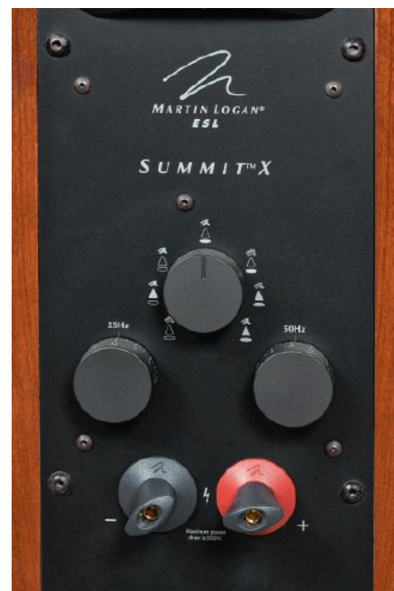
Ponad parę zacisków widać trzy pokrętki. Dwa, ułożone na skraju, służą korekcie charakterystyki przy częstotliwościach 25 Hz i 50 Hz; środkowe z akustyką nie ma nic wspólnego – wybieramy nim kombinację włączonych diod oświetleniowych.
