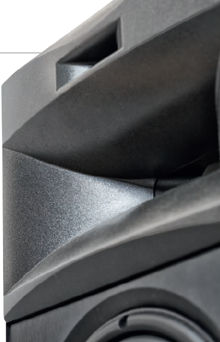
Tajemnica sukcesu i dobrego brzmienia przetwornika tubowego tkwi zarówno w wielu niewidocznych z zewnątrz elementach, jak i w tym, co od razu rzuca się w oczy – sposobie wyprofilowania tuby. Niewielka zmiana kształtu i rodzą się zupełnie inne charakterystyki.
