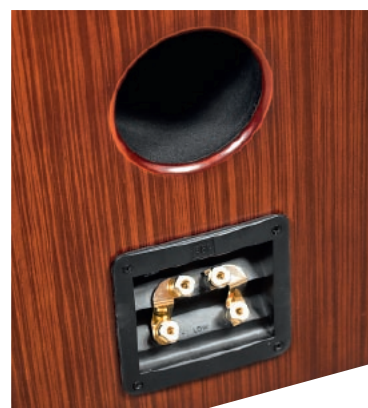
Z tyłu również użycie – otwór bas-refleks ma na tyle dużą średnicę, że konstruktor nie bał się turbulencji i nie uznał za konieczne wykonania wyprofilowania jego wylotu. Nie widział również potrzeby „zalecania się” do klientów luksusową oprawą gniazda przyłączeniowego – plastikowa „puszka” wygląda w tak zaawansowanej konstrukcji bardzo skromnie, i chociaż nie przypisywałbym jej wpływu na brzmienie, to na samopoczucie niektórych audiofilów – już tak.
